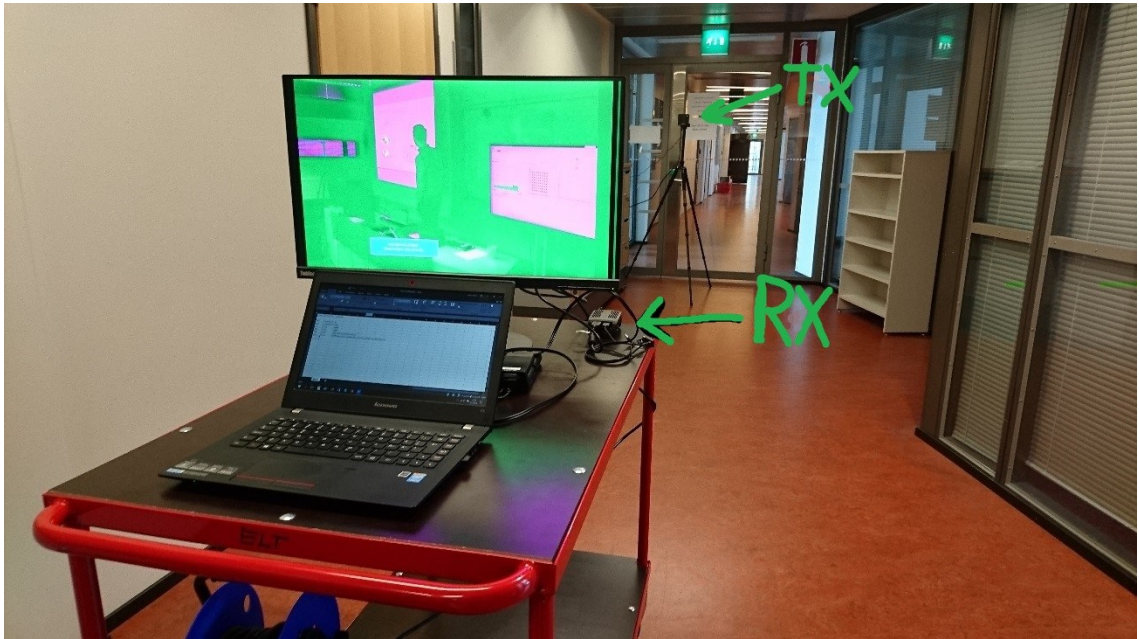
Kuva 3. Kuva TPCAST-testilaitteistosta. TX tarkoittaa lähetinyksikköä ja RX tarkoittaa vastaanotinyksikköä.
